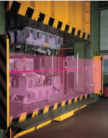
**Prensa hidráulica: combinación de protección de la zona de trabajo (cortina opto-electrónica de SICK) y monitorización interior (escáner láser PLS de SICK). Para la puesta en marcha están activados ambos sensores. Posteriormente, en la fase de cierre el PLS está inhibido.**
