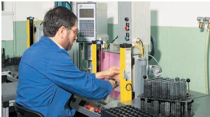
**Protección de una prensa punzonadora empleando una cortina fotoeléctrica de SICK con inicio de ciclo por simple o doble corte de los haces de la cortina.**
